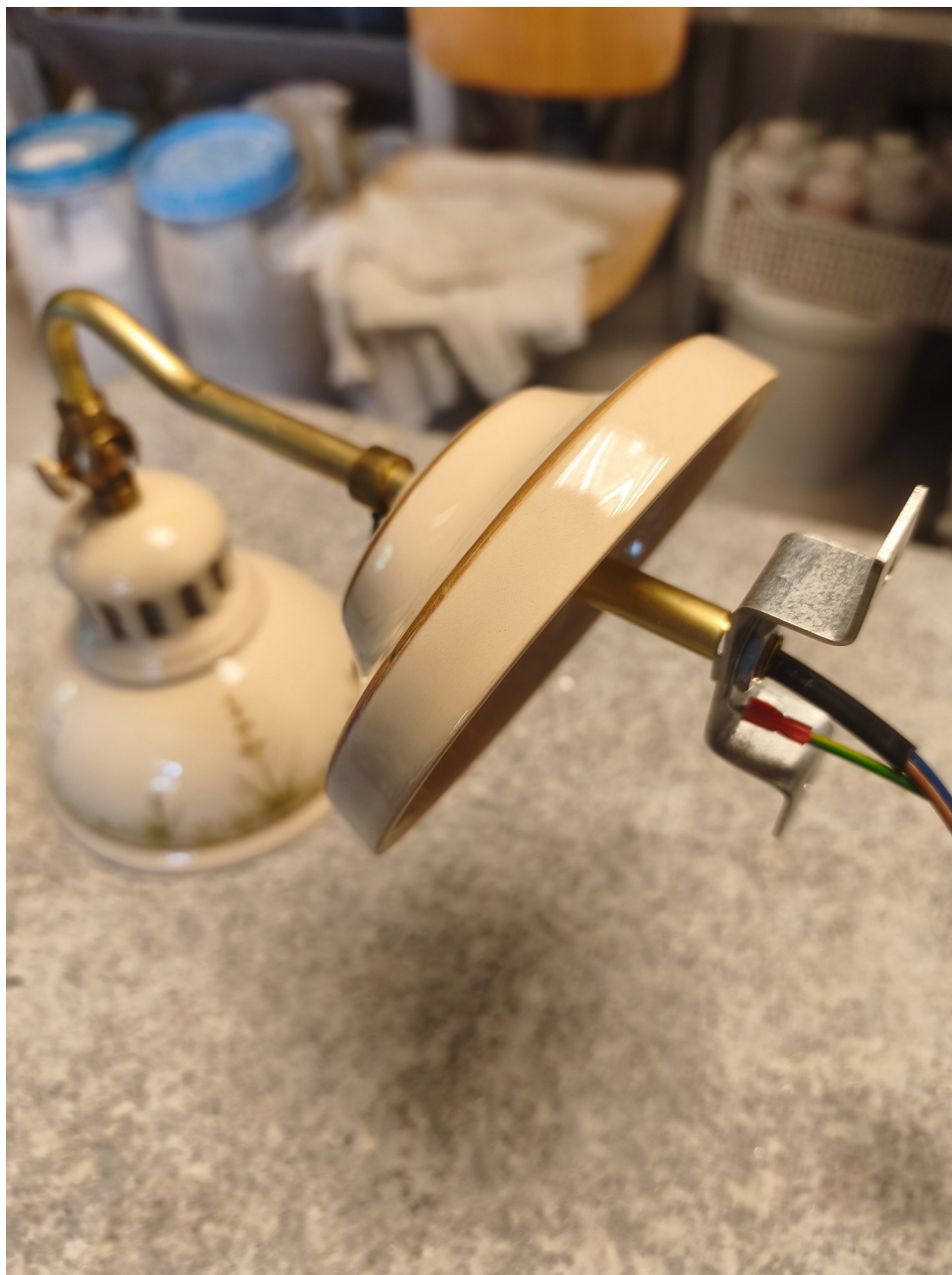
5. kép - Oldalnézet: a kerámia takaróelem, a sárgaréz kar és a rögzítőkonzol egymáshoz viszonyított helyzete.
