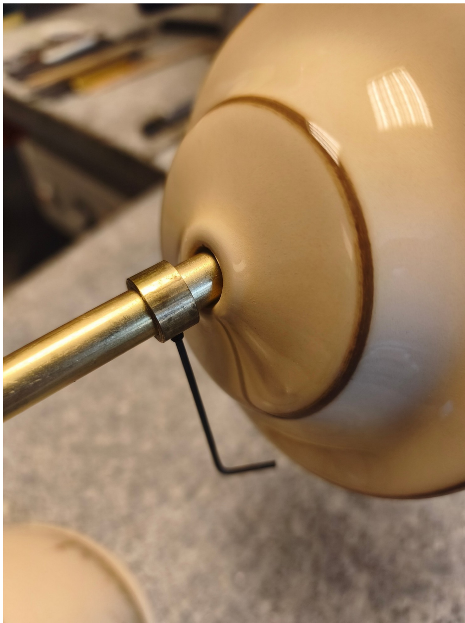
6. kép - A fém persely és az imbuszos hernyócsavar, amely a kerámia elem helyzetét rögzíti.
